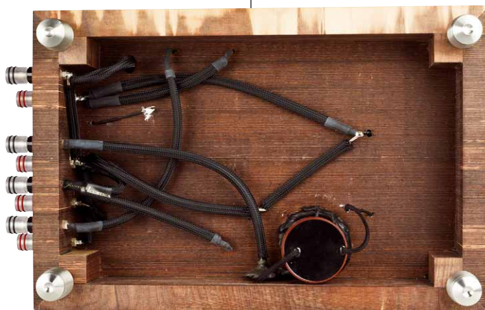
Das Wahwitz-Filter von unten: Der Löwenanteil der Bauteile sitzt obendrauf, das Gehäuse ist aus Panzerholz
